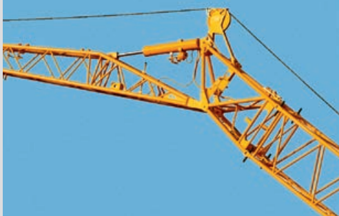
Гидравлически переставляемый откидной удлинитель ( 0^\circ - 45^\circ )
